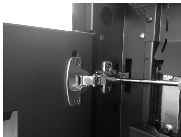
Fig. 48 - Réglage de la porte
