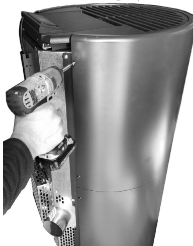
Fig. 71 - Retrait des vis arrière
