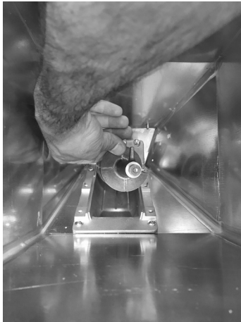
Fig. 85 - Retrait des spirales
