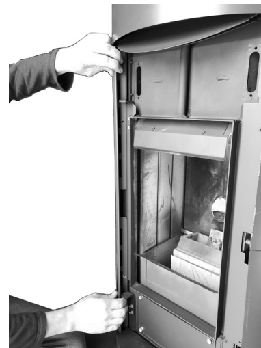
Fig. 70 - Retrait des profils avant (droit et gauche).
