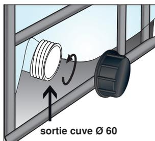
sortie cuve Ø 60
