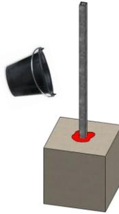
4 – Mettre le fer de niveau avant la prise de béton
