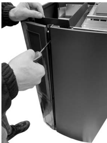
Fig. 47 - Retirer les vis
