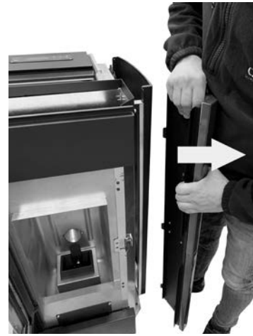
Fig. 51 - Retirer le profil.
