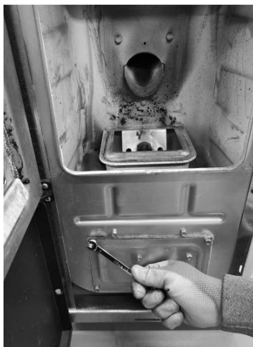
Fig. 68 - Retirer les vis
