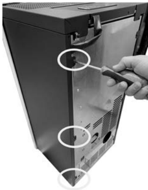
Fig. 38 - Retirer les vis
