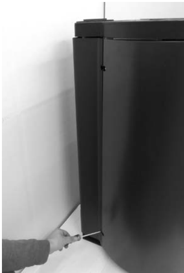
Fig. 65 - Dévisser les vis latérales
