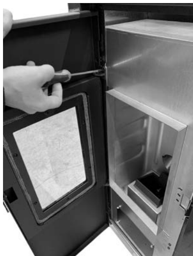
Fig. 33 - Retrait des vis
