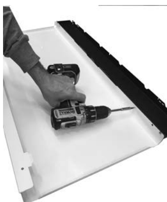
Fig. 45 - Fixer le flanc coloré
