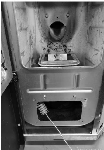
Fig. 70 - Nettoyer avec un goupillon.
