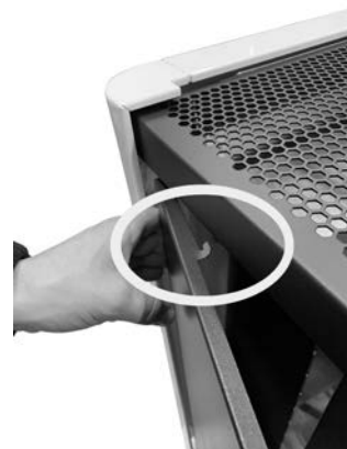
Fig. 40 - Dents de fixation
