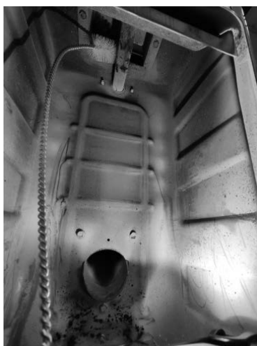
Fig. 72 - Nettoyer avec un goupillon.
