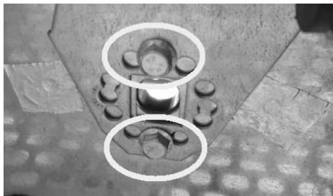
Fig. 76 - Retirer les vis
