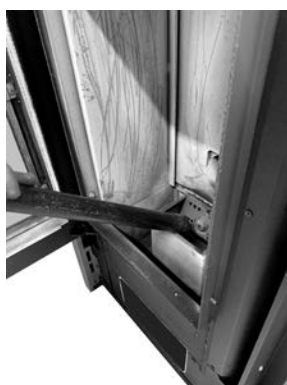
Fig. 29 - Nettoyage l'espace du brasero
