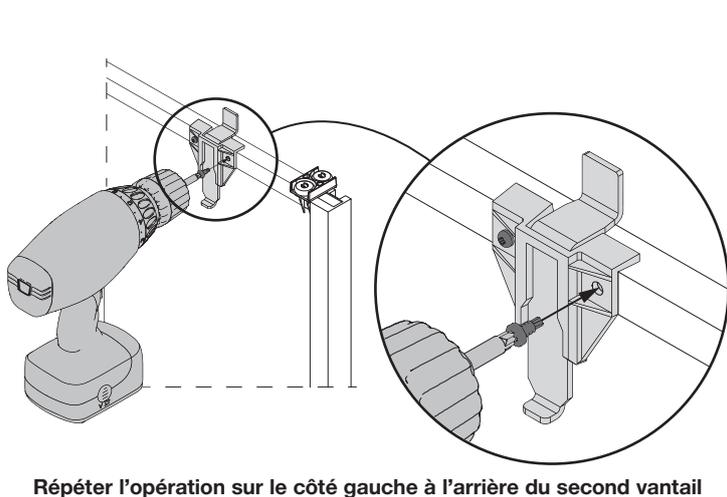
Répéter l'opération sur le côté gauche à l'arrière du second vantail
