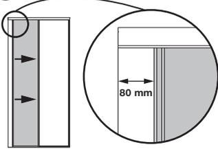
**2** Relever la partie métallique du déclencheur en passant la main dans l'ouverture de 80 mm
