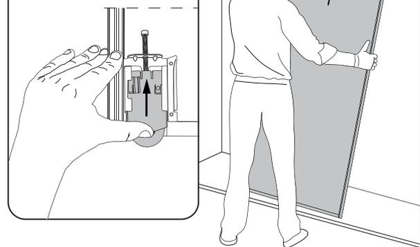
**9 Régler l'ergot déclencheur sur la hauteur**
