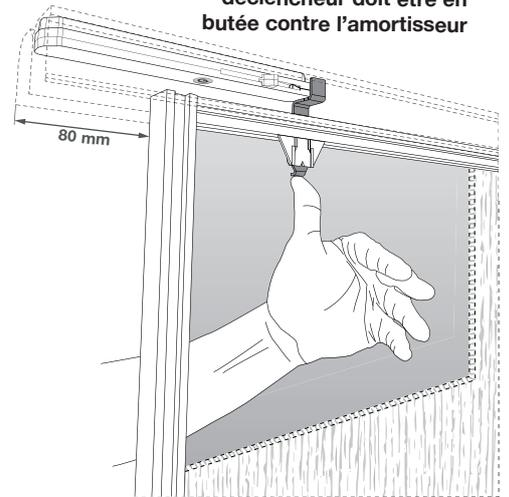
**4** Descendre de 2 mm la partie métallique du déclencheur
