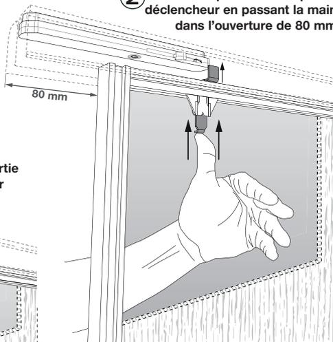
**3** La partie métallique du déclencheur doit être en butée contre l'amortisseur
