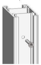
7 – Réaliser un perçage (diamètre 5 mm) à la base du poteau afin de drainer la condensation en dehors de celui-ci
