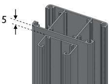
✓ Poteau d'angle différent de 90° (utilisation de 2 poteaux et 2 closoirs de finition)
