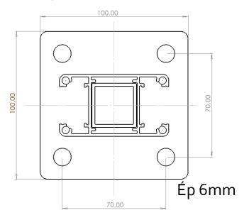
Il est nécessaire d'avoir un socle béton pour la fixation des platines.
