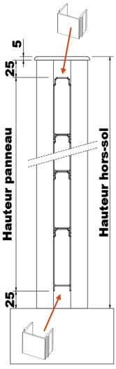
Closoir alu longueur 25 mm (\*Dans le cas d'une pose sur platine, le closoir sera de 17 mm et dans le cas d'une pose sur platine renforcée, le closoir sera de 19 mm)
