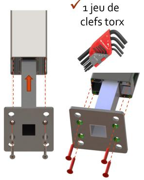
Vérifiez l'aplomb des poteaux sur les 2 faces pendant l'installation
