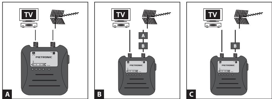
FR - Branchez le câble venant de l'antenne sur l'entrée n°3 suivant la configuration de l'installation :
