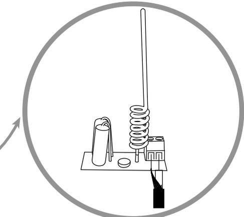
Si vous souhaitez améliorer la portée de vos télécommandes, vous pouvez brancher l'antenne située dans le feu clignotant avec un câble coaxial type RG58 (non fourni). Dans ce cas, vous devez déconnecter l'antenne d'origine. Branchez le cuivre central du câble coaxial sur la borne «ANT» et la tresse sur la borne «GND», côté antenne et côté carte électronique.
