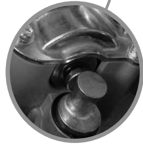
Position du moteur déverrouillé : Le téton doit être en position enfoncée
