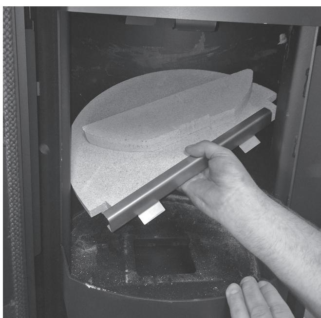
► Un deuxième déflecteur métallique est situé au-dessus du déflecteur en vermiculite. Veuillez le soulever légèrement (G) et le tirer vers l'avant (H). Faites-le ensuite pivoter au-dessus du boulon d'appui pour le retirer.
