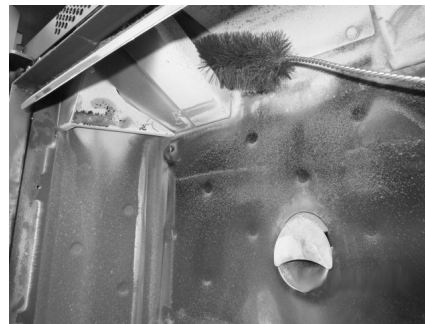
Fig. 40 - Nettoyage avec un goupillon
