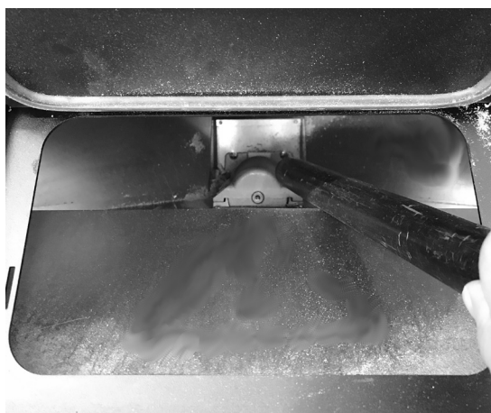
Fig. 35 - Nettoyage réservoir et vis sans fin
