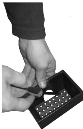
Fig. 32 - Nettoyage du brasero
