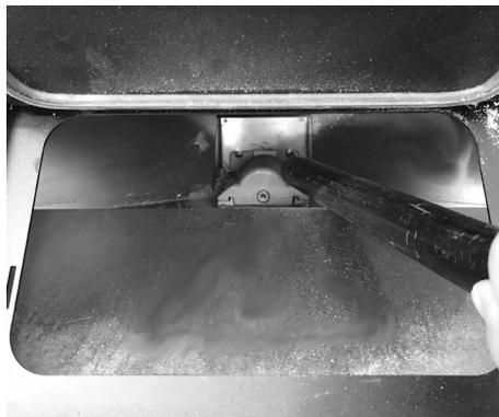
**Fig. 25 - Limpieza depósito y coclea**
