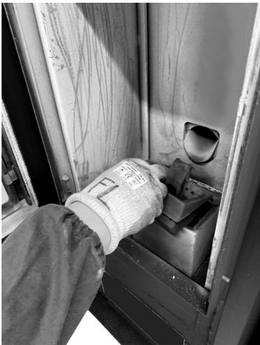
**Fig. 21 - Extracción del brasero**
