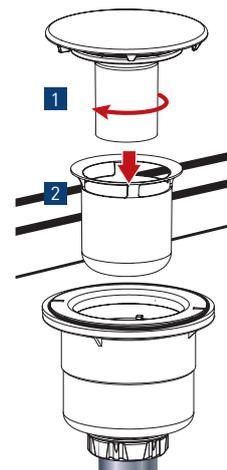
E/ Faire un test en eau pour vérifier l'étanchéité.
