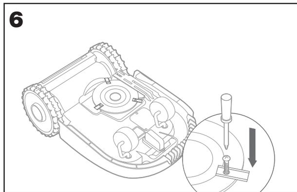
**⚠ Attention:** lorsque vous montez de nouvelles lames, assurez-vous de remplacer **TOUTES** les lames. Utilisez toujours de nouvelles vis lors du montage des lames. Ceci est essentiel pour garantir la stabilité de la lame et l'équilibre du disque tournant de lame. La non-utilisation de vis neuves peut entraîner des blessures graves. Important : Après avoir vissé la lame au disque de coupe, assurez-vous que la lame est capable de tourner librement.
