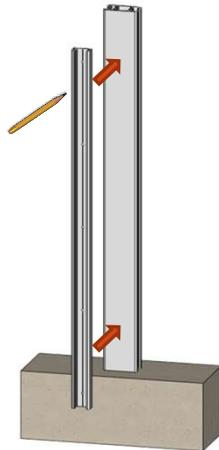
4 – Percer le poteau au diamètre 3 mm
