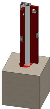
4 – Réaliser un perçage (diamètre 5 mm) à la base du poteau afin de drainer la condensation en dehors de celui-ci
