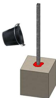
3 – Mettre le poteau à niveau avant la prise de béton
