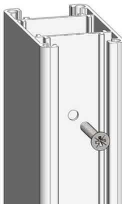
7 – Réaliser un perçage (diamètre 5 mm) à la base du poteau afin de drainer la condensation en dehors de celui-ci
