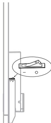
Le bouton Marche/Arrêt vous permet de mettre votre appareil en veille. En revanche, l'interrupteur coupera entièrement l'alimentation de votre appareil et il vous sera nécessaire de reparamétrer l'heure et la date par la suite.
