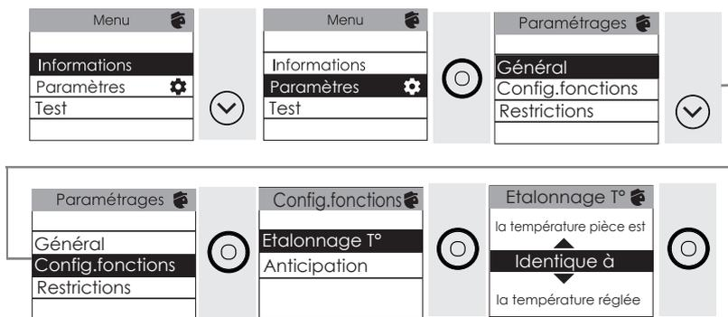
Pour un confort optimal, nous vous recommandons de démarrer la chauffe de votre sèche-serviettes quelques minutes avant le moment de l'utilisation de la salle de bains (entre 5 et 30 min). Si vous souhaitez que l'appareil anticipe automatiquement la chauffe en fonction de la programmation définie, vous pouvez activer la fonction d'anticipation de la chauffe.
