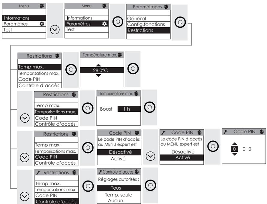
A noter : Si les restrictions de contrôle d'accès « Temp. Seule » ou « Aucun » sont activées, il ne sera pas possible d'appairer le produit dans l'application et de le piloter à distance. La touche boost et la touche on/off restent actives lorsque les restrictions de contrôle d'accès « Temp. Seule » et « Aucun » sont activées
