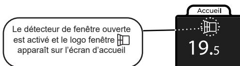
*i* En cas de détection de fenêtre ouverte, le logo fenêtre s'affiche en grand à l'écran et un signal sonore retentit. Un appui sur le bouton veille remettra automatiquement le chauffage en fonctionnement.
