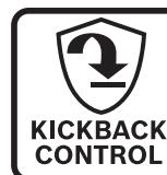
Le dispositif d'arrêt rapide (Kick-Back Control) améliore la maîtrise de l'outil électroportatif et donc la sécurité d'utilisation par rapport aux outils électroportatifs sans KickBack Control. L'outil électroportatif s'arrête immédiatement dès qu'il se met subitement, et de façon imprévisible, à tourner autour de l'axe du foret.
