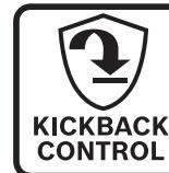
Snabbavstängningen (KickBack Control) ger bättre kontroll över elverktyget och ökar därmed användarsäkerheten jämfört med elverktyg utan KickBack Control. Vid plötslig och oförutsebar rotation runt borraxeln stängs det av.
