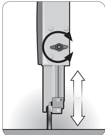
Ajuster la hauteur de coupe en fonction de la pièce à usiner.
