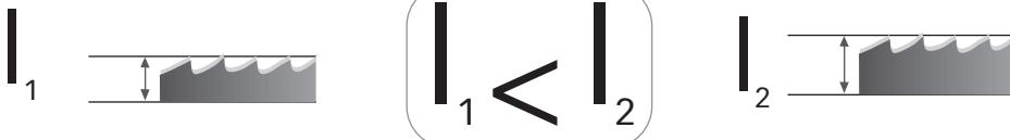
Plus la largeur de la lame est faible et plus je peux chantourner.
