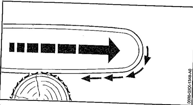
Lorsqu'on travaille avec le côté inférieur du guide-chaîne, la tronçonneuse est tirée dans le sens opposé à l'utilisateur.
