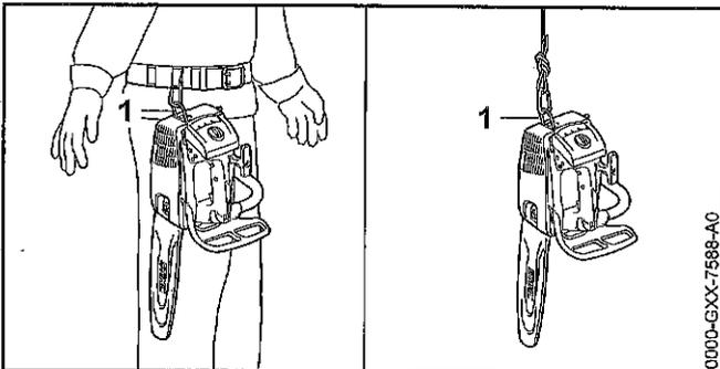
Avec l'anneau de suspension (1), la tronçonneuse peut être accrochée à la ceinture ou suspendue à un câble.
