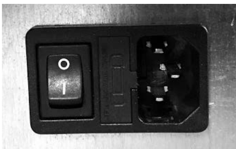
Fig. 80 - Prise électrique avec interrupteur général
