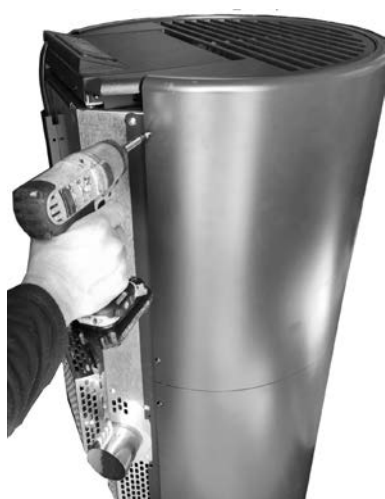
Fig. 72 - Retrait des vis arrière
