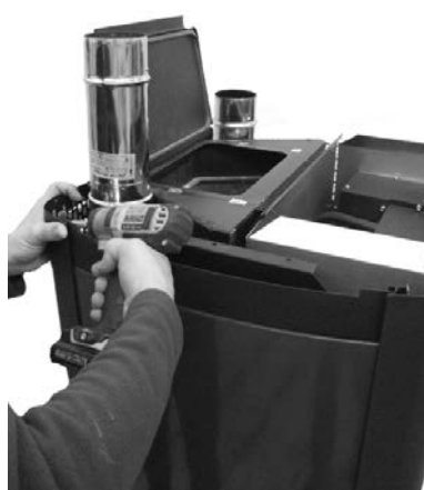
Fig. 105 - Dépose des profils courbes supérieurs
