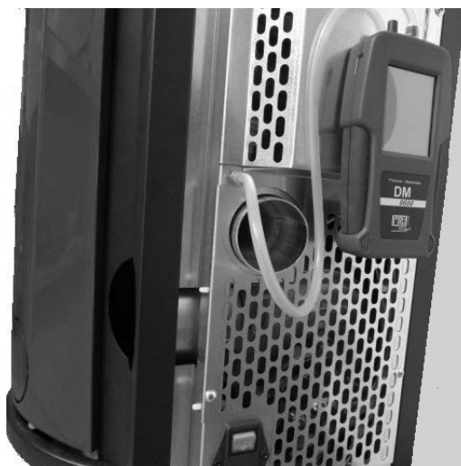
Fig. 69 - Connexion du pressostat numérique
