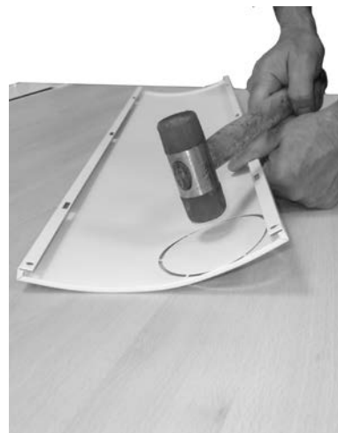
Fig. 52 - Ouvrir le trou (modèle Sfera 3 Plus)
