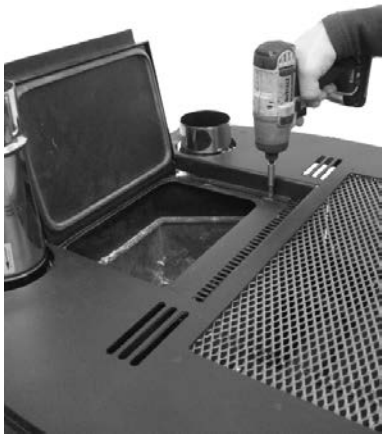
Fig. 55 - Levée les vis supérieurs
