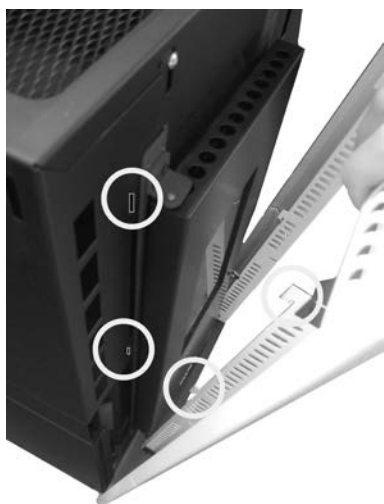
Fig. 44 - Assembler le panneau frontal
