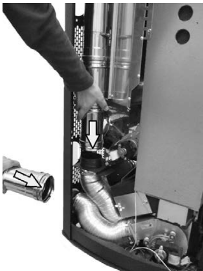
Fig. 77 - Positionnement des tuyaux pour la canalisation
