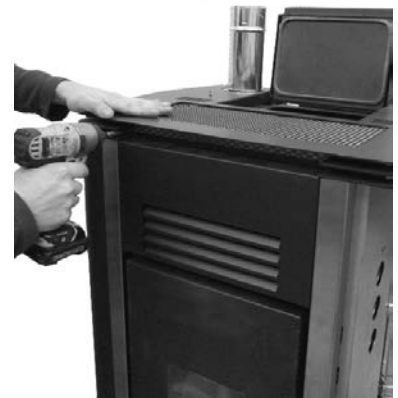
Fig. 57 - Levée les vis frontal
