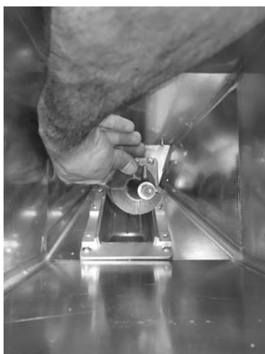
Fig. 87 - Retrait des spirales
