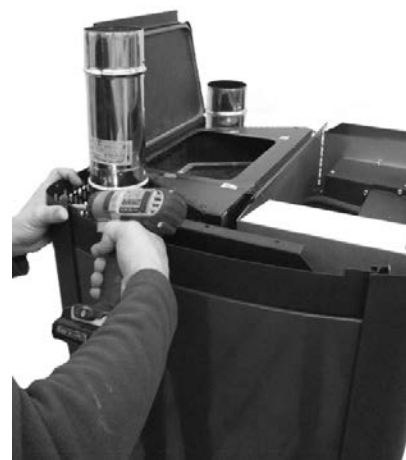
Fig. 61 - Repositionnement des profilés courbés supérieurs
