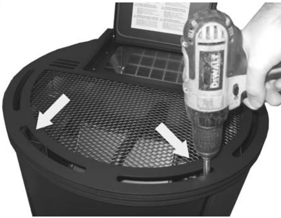
Fig. 95 - Enlèvement des vis du couvercle 1
