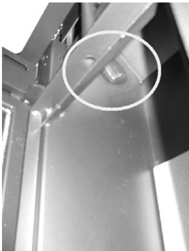
Fig. 110 - Passages des fumées
