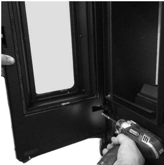
Fig. 99 - Desserrer la vis
