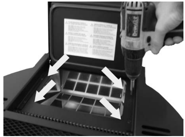
Fig. 96 - Enlèvement des vis du couvercle 2
