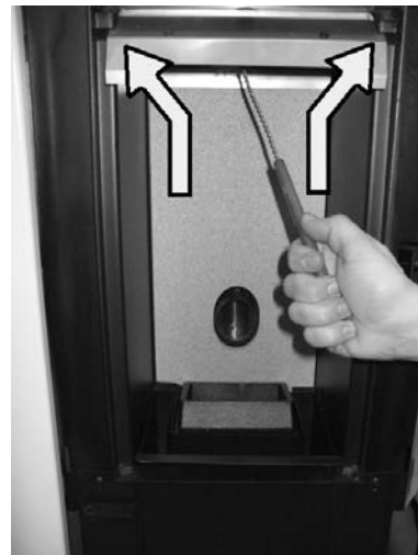
Fig. 112 - Nettoyer les deux conduits
