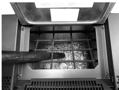
Fig. 32 - Nettoyage réservoir et vis sans fin
