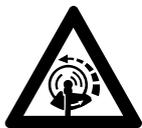
Ne pas lancer le moteur en tenant la machine « à bout de bras » – pour la mise en route du moteur, procéder comme décrit dans la Notice d'emploi. Lorsqu'on relâche la gâchette d'accélérateur, l'outil de coupe tourne encore pendant quelques instants – **par inertie !**
