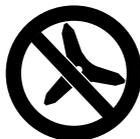
Il est interdit d'utiliser ce capot protecteur avec des couteaux à taillis.
