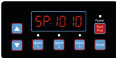
Diagramme 4.10, 1000 RPM appuyez sur “Haut” une foi
