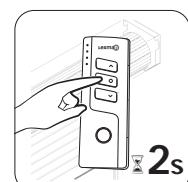
5) Appuyez sur le bouton arrêt de la télécommande pendant 2s, le moteur tournera vers la troisième limite
