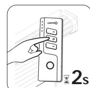
5) Premere il pulsante di arresto del telecomando per 2 secondi, il motore passerà al terzo limite.
