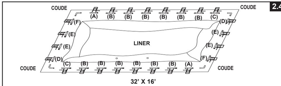
3. Assurez-vous que le liner soit complètement déplié et bien étendu sur le tapis de sol. Commencez par les grands côtés, insérez la poutre 'A' en premier dans les bordures du liner situées dans chaque coin. Continuez avec les poutres 'B' en les clipsant dans la poutre 'A' puis la poutre 'C' dans les poutres 'B' (voir dessin 3).
