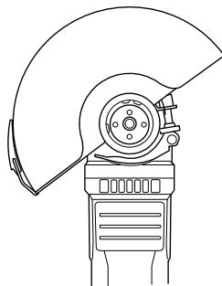
Utilize a cobertura de proteção da rebarbadora para a operação de esmerilagem.
