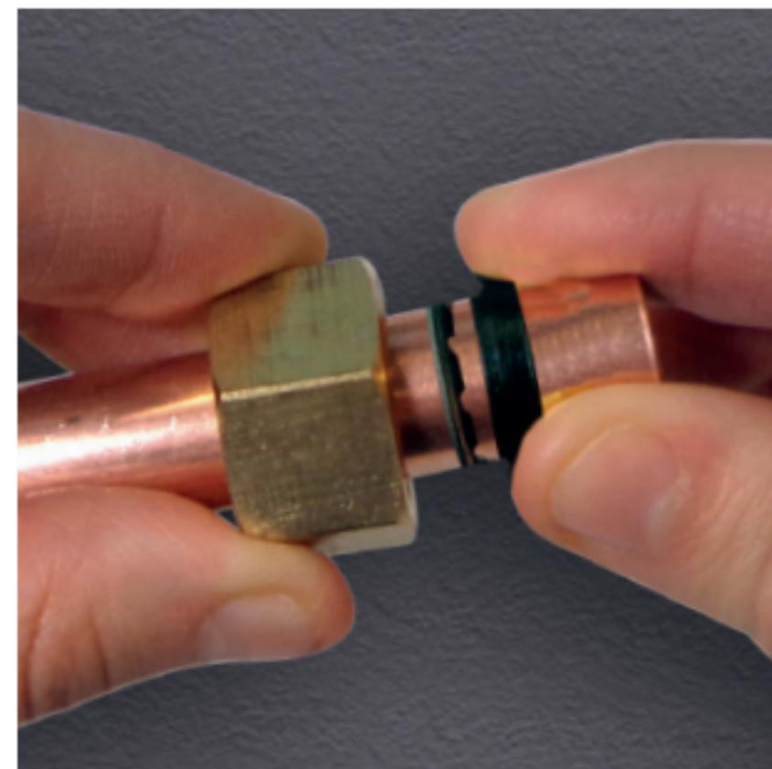
4 - vissez l'écrou sur le raccord
