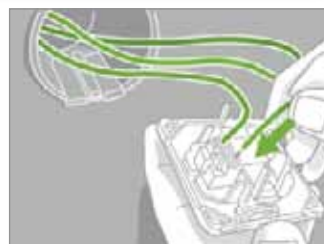
Insérez les fils dans les connecteurs rapides et poussez à fond jusqu'au blocage.
