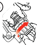
Houd de spaninrichting stevig vast en draai de boor vast met het kartelwielletje zodat hij niet meer beweegt. U bent klaar om te beginnen slijpen
