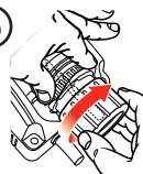
Maintenez fermement le mandrin et serrez le foret avec la molette afin qu'il ne bouge plus. Vous êtes prêt pour l'opération d'affûtage.
