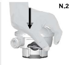
**Notes: Le Quick-on+ est conçu de façon à rendre impossible son montage sur la valve si le robinet n'est pas en position fermée; ne jamais tenter de le monter ou de le démonter, si le robinet n'est pas dans cette position.**
