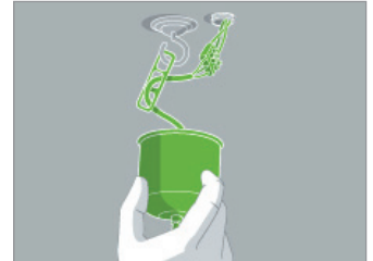
Suspendez la barrette au crochet de la cheville et procédez au raccordement du luminaire.
