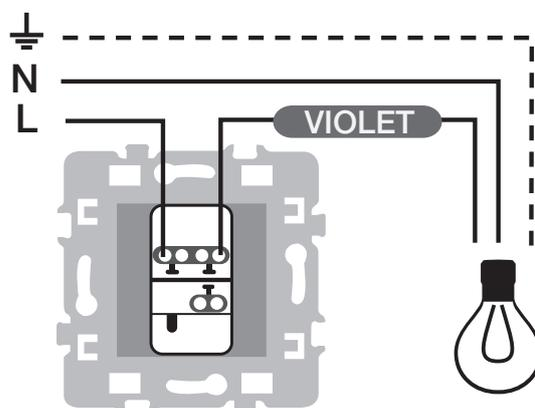
SCHEMA 2 | 2 Points de Commande Va et Vient
