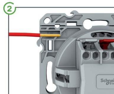
Mesurer la longueur des fils à dénuder en utilisant le gabarit intégré au produit (13 mm)
