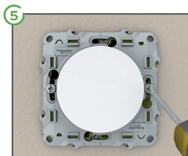
Mettre à niveau l'appareil et le fixer
