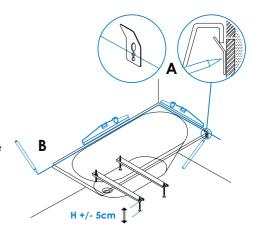
↑ Si vous souhaitez monter un tablier de baignoire (habillage vendu séparément), le bas du contour de la baignoire doit être ajusté en fonction de la hauteur du tablier.
