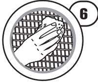
**6** Nettoyer les joints **avant séchage** complet à l'aide d'une éponge légèrement humide.
