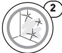
**2** S'assurer que les surfaces soient sèches, lisses et propres. Pour une pose en espace humide (exemple : douche), une solution d'étanchéité doit être préalablement mise en œuvre. Les trames des feuilles peuvent être coupées à l'aide de simples ciseaux.
