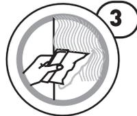
**3** Encoller le support avec une colle à carrelage blanche de type C2S ou époxy (voir notice du fabricant).
