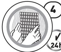
**4** Positionner les feuilles sur le support encollé, utiliser un platoir ou une batte pour une pose plane et uniforme. Utiliser des croisillons pour garantir un espacement homogène entre les feuilles. Respecter le temps de séchage préconisé. **24h**
