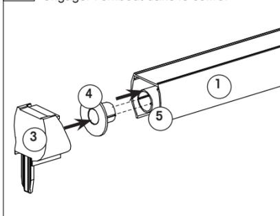
**6** Engager l'embout dans la barre finale et la toile dans l'embout.
