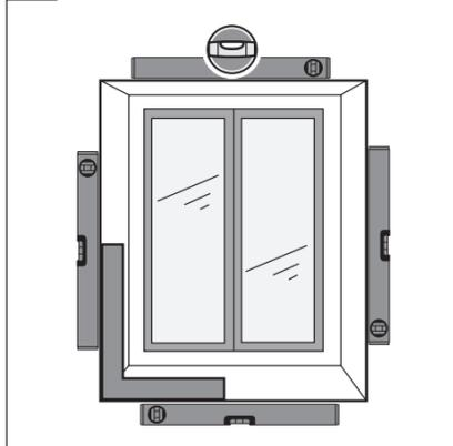
**2** Mesurer les dimensions du tableau à plusieurs endroits. **Retenir la hauteur et la largeur minimum.**
