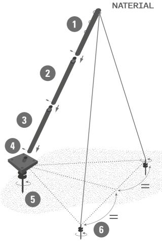
Serrer les deux cordes sur l'anneau arrière du mât et les tendre jusqu'aux sardines positionnées comme montré dans le schéma. Les cordes doivent être tendues et bien fixées tant au mât qu'aux sardines pour créer une tension sur le mât.
