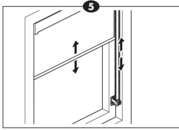
**NL** De kettingspanner moet op de maximale afstand vanaf het bedieningsmechanisme gemonteerd worden om te voorkomen dat de ketting slap komt te hangen.
