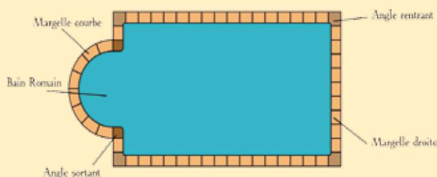
Les margelles doivent être posées uniquement sur la maçonnerie constituant l'ossature de la piscine. Leur liaison au dallage doit être assurée par un joint compressible, quel que soit le type de pose des produits de dallage.
