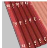
6 15 fixations minimums doivent être utilisées par plaque. Attendez de fixer la dernière onde avant de recouvrir celle-ci par la plaque suivante.
