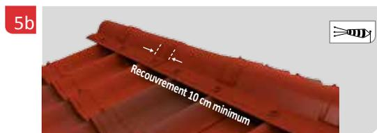
5b Couvrir le faîtiage avec la faîtière mince et la fixer en sommet d'onde, à travers les closoirs de faîtiage, de chaque côté du toit. Le sens de pose s'effectue dans le sens contraire des vents dominants.
