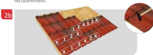
2b La fixation à chaque sommet d'onde doit être réalisée dans l'ordre avec les fixations ONDUVILLA®, entre les 2 guides de recouvrement. Ne pas fixer ces ondulations qui seront recouvertes par la tuile suivante ou pièce de rive.
