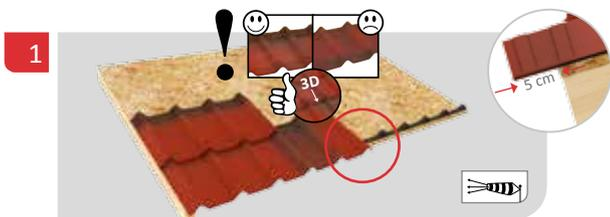
1 Commencez la pose des éléments dans le sens contraire du vent. Positionnez un cordeau à 5 cm du bord de chaque côté de votre toit. Positionner les closoirs en mousse sous les ondes de la première rangée de tuiles.
