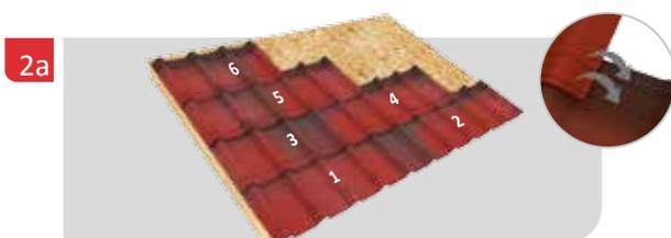
2a Posez les éléments en partant du bas vers le faîtiage. Respectez le bord du cordeau pour le débord. Décaler la pose, en commençant la deuxième rangée avec une demi-tuile. Assurer l'étanchéité en alignant les guides de recouvrement.
