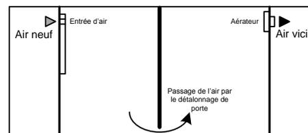
**Principe d'installation par Balayage**
