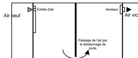
**Principe d'installation par Balayage**
