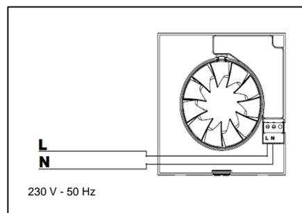
S'il n'est pas possible de ramener un troisième fil de la borne Ls à la sortie de l'interrupteur, l'appareil peut recevoir uniquement la phase et le neutre. Dans cette configuration de branchement, la marche forcée sera inhibée. L'appareil ne fonctionnera qu'en mode automatique basé sur la détection de l'hygrométrie (pas de marche forcée).
