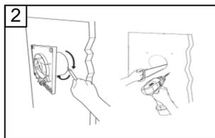
Utiliser le support de l'appareil pour repérer le trou du conduit et les trous de fixations
