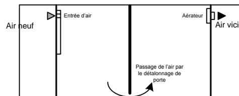
**Principe d'installation par Balayage**
