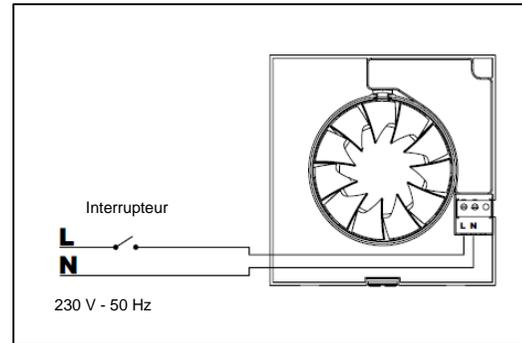
Lorsque l'interrupteur sera sur ON, l'appareil fonctionnera jusqu'à ce que l'interrupteur soit à nouveau sur OFF
