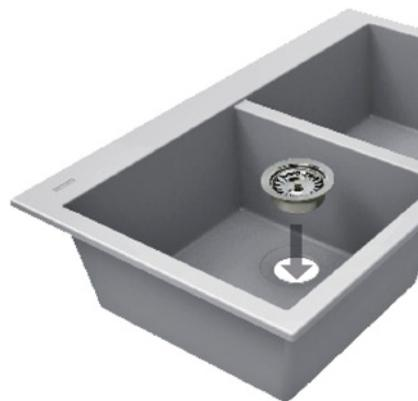
**3** - Fixer avec la vis de fixation sans trop serrer.
