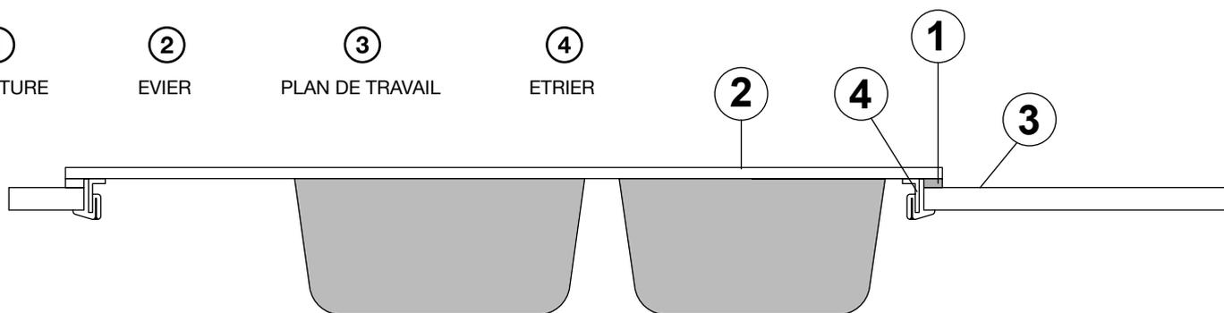
Vous devez soigneusement placer du silicone transparent ou un joint approprié (1) sur la surface supérieure du plan, au niveau du bord de la découpe (845x485 mm - 970x480 mm - 980x490 mm - 1150x490 mm). Poser avec précaution l'évier sur le joint (1) en le centrant dans la découpe. Serrer les supports de montage (4) avec un tournevis en vous assurant que l'évier est bien positionné sur le plan et contre le joint.
