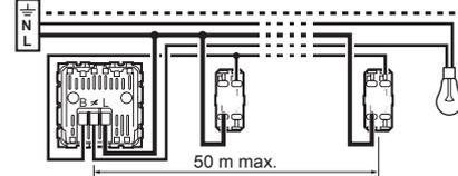
Fonction télérupteur comprise, à ne pas utiliser avec un télérupteur au tableau électrique
