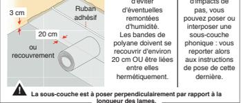
Si cela s'avère nécessaire, disposer un film polyane afin d'éviter d'éventuelles remontées d'humidité. Les bandes de polyane doivent se recouvrir d'environ 20 cm OU être liées entre elles hermétiquement.
