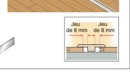
Les dimensions maximum où il ne faut pas faire de jeux de dilatation sont de 8m de large sur 20m de longueur. La largeur de la pièce ne doit pas dépasser 8m et la longueur 20m. Le parquet se pose du côté le plus long. Si les dimensions sont supérieures, il faut prévoir un jeu de dilatation quelque part dans la pièce.
