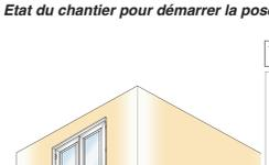
La pose du parquet est la dernière étape avant l'installation des meubles. Les travaux de plâtrerie, de peinture, d'installation des fenêtres, des portes, de plomberie etc. doivent être finis. La pièce sera parfaitement sèche, fermée et la température sera d'au moins 15°C. Ne pas poser le parquet si l'hygrométrie de l'air ambiant n'est pas comprise entre 45% et 65%.
